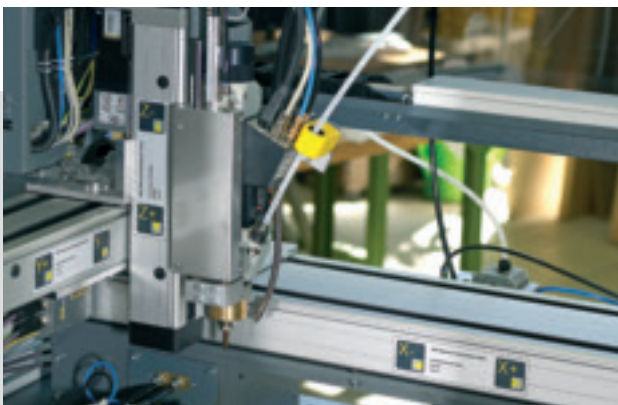
Abb. links: Der hochleistungsgesteuerte Präzisionsschweißkopf KAH 412 erzielt beste Ergebnisse für alle Schweißverfahren.
