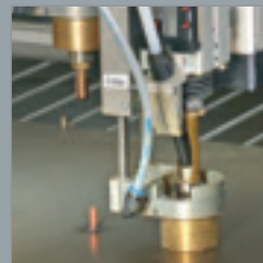
Niederhalter Komponente zum Niederhalten des Werkstücks
