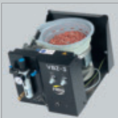
VBZ-3 Vollautom. Bolzenzuführung, Bolzen-Ø: 3 – 10 mm, Bolzenlänge: 6 – 50 mm, Förderleistung: bis zu 30 Bolzen/min (je nach Schweißelement und Zuführschlauch)
