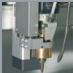
FSE-Komponente Flüssigkeitssprüheinheit zum benetzen/besprühen der Schweißposition vor dem Schweißen (Pulsdosierung)
